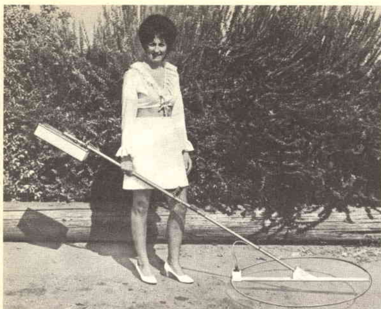
Fig. 1 - Uno degli ultimi cercametri per grandi profondità è il Gardiner, provvisto di una bobina di ricerca del diametro di 90 cm.
