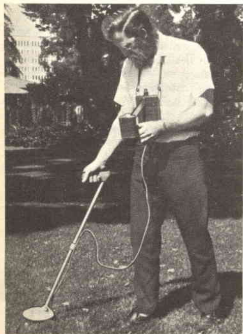
Fig. 2 - Nel cercametri Fisher Explorer II, la parte elettronica è montata a parte e provvista di una cinghia che il ricercatore appende al collo.
